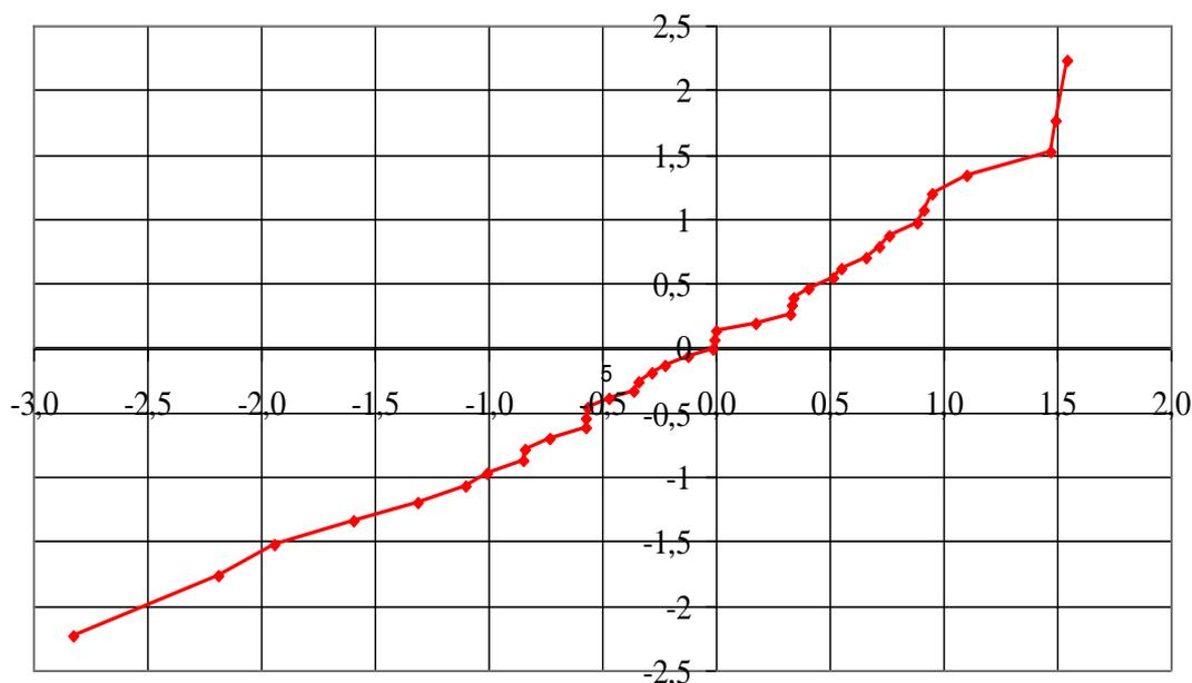
Рис. 8. Эмпирическая функция распределения нормированных ошибок определения времени подъема (39 наблюдений, имеющих теоретическое время подъема больше 80 сек).
