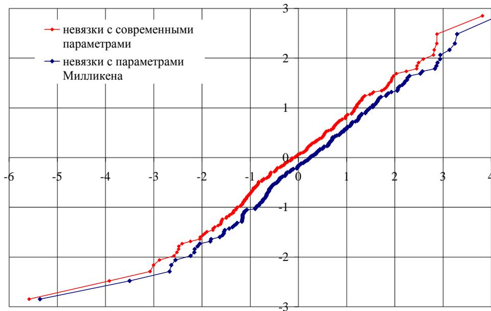
Рис 12. Сравнение нормированных ошибок (невязок) в измерении времени падения при вычислении теоретического времени с параметрами Милликена и современными параметрами.
