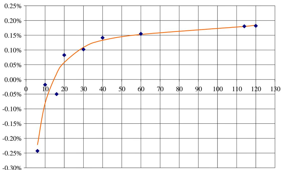
Рис.1 Поправка хроноскопа  $y$  (в %) в зависимости от измеряемого интервала времени  $x$  (в сек).
