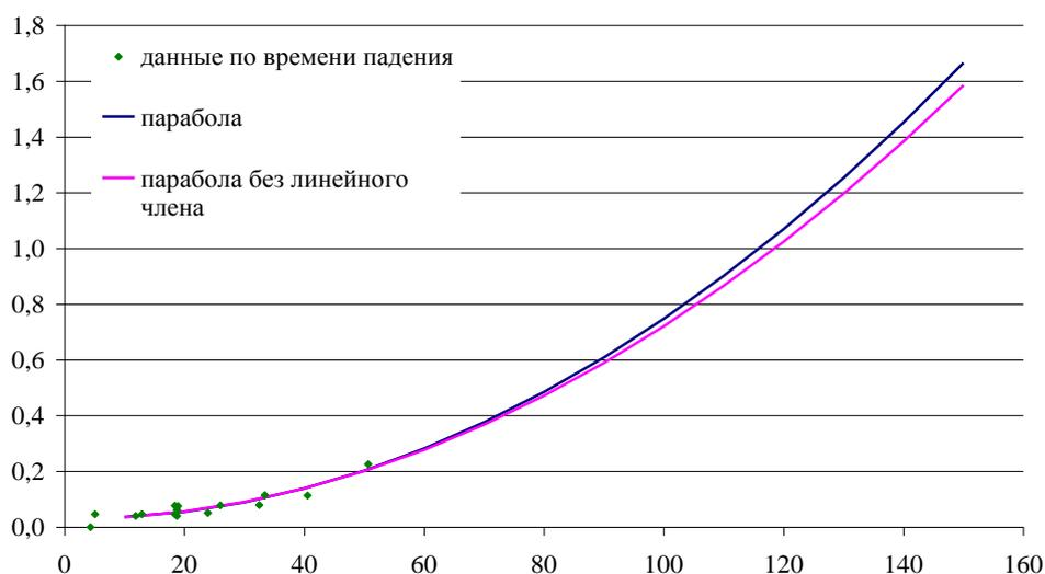
Рис. 7. Сглаживание и экстраполяция стандартных отклонений ошибок измерения времени падения в зависимости от теоретического времени падения.
